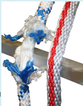
Generația 3. Funie cu nucleu și înveliș împletit paralel (Paraloc)
